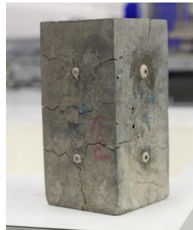
Figure 1 : éprouvette atteinte de RSI
